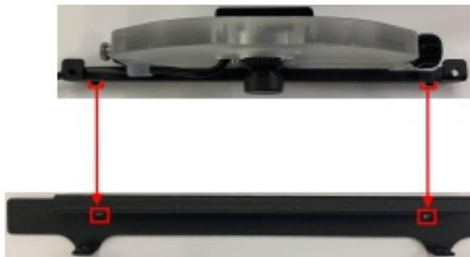
6. Coloque los dos tornillos M2L20 en el soporte para fijar la cámara a la cubierta central del CE7000-40.
