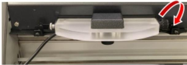
3. Ajuste el ángulo de la cámara de modo que la ranura de la cubierta frontal del CE7000 se alinee con las líneas de referencia del software iMark Plus, como se muestra en la imagen a continuación.
