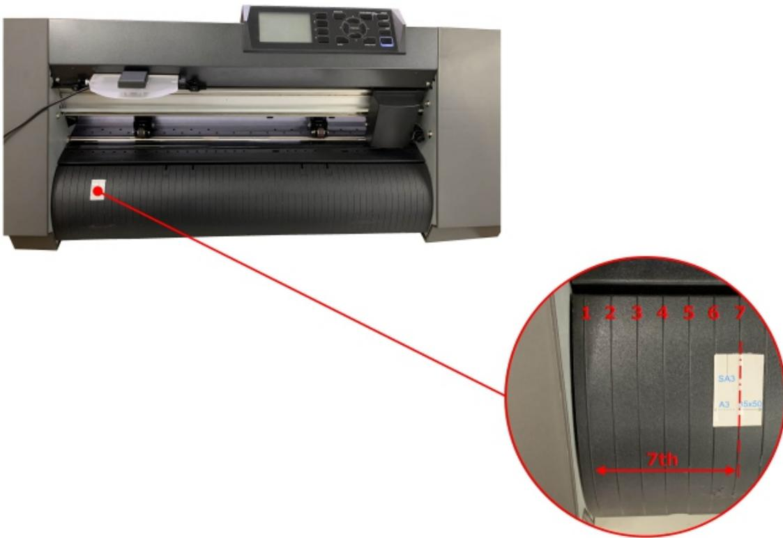
6. Conecte el F-Mark2 al CE7000-40 de modo que el borde frontal del F-Mark2 encaje en la ranura de la cubierta frontal del CE7000-40.
