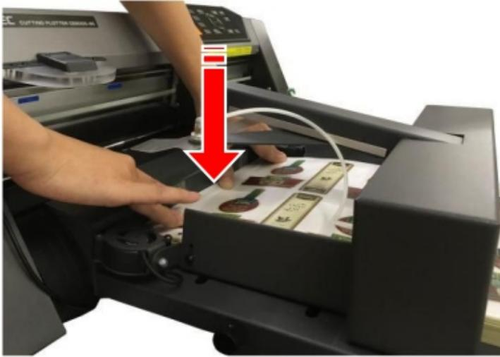
4. Al utilizar sopladores, ajuste su velocidad de rotación y el ancho de la guía lateral del material para que el material se eleve ligeramente.
