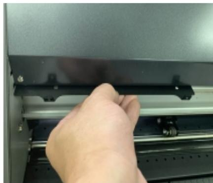
4. Coloque el soporte en el lado izquierdo de la cubierta central del CE7000-40 como se muestra en la imagen a continuación. Empújelo completamente hacia la izquierda como indica la flecha 1 y luego tire de él en la dirección de la flecha 2.
