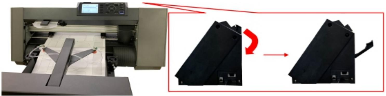
2. Extraiga la punta del material hacia la parte delantera del rodillo de empuje del CE7000-40. A continuación, cambie la posición de la F-Mark2 para que la marca de corte de la hoja de prueba quede debajo de la cámara.
