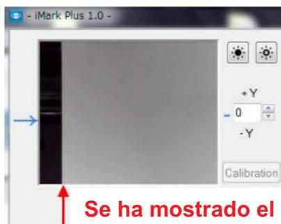
Si el borde del medio no se muestra en la vista previa de la cámara, se mostrará el mensaje de error "Borde de la hoja no encontrado" al leer la primera marca de recorte con la cámara.
